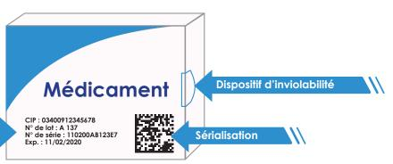
Un identifiant unique encodé contenant le numéro de série (sérialisation) et encodé sous la forme d'un datamatrix
